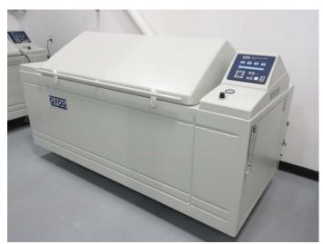
Chambre brouillard salin utilisée
