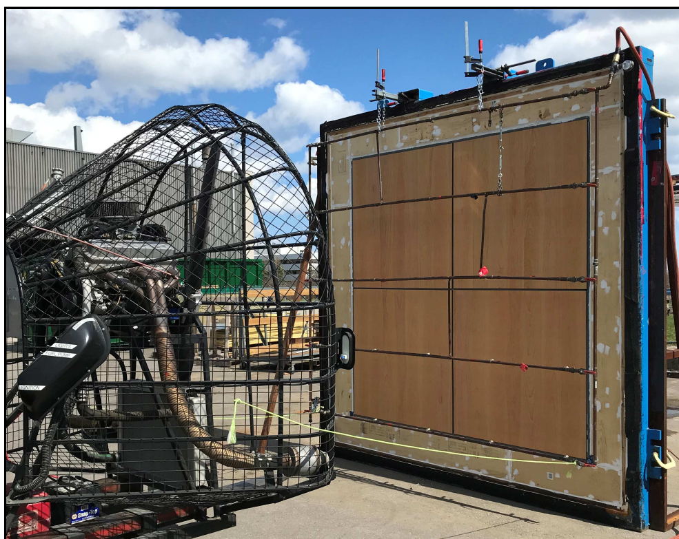
Figure 4 – Norme AAMA 501.1, essai de pénétration d'eau sous pression dynamique
