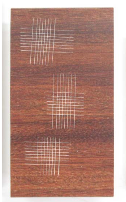
Échantillon après les essais d'adhésion
