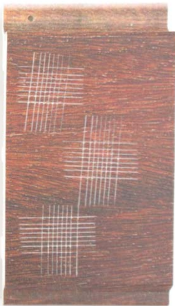
Échantillon après les essais d'adhésion
