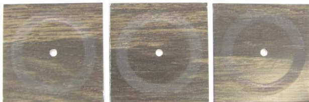
Échantillons : DiZal après le test d'abrasion
