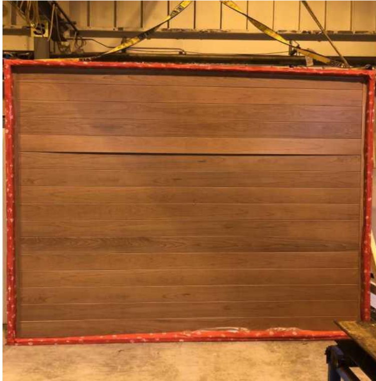
Photo 2 - Post-test de la section du mur (bardage horizontal)
