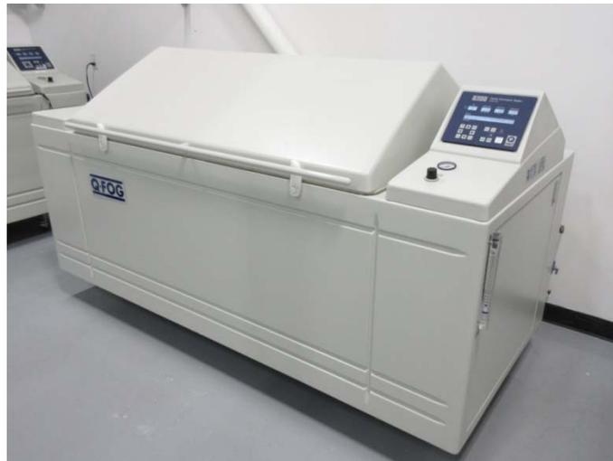
*Chambre brouillard salin utilisée*
