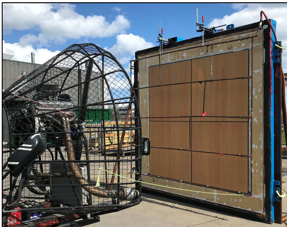
Figure 2 – Norme AAMA 501.1, essai de pénétration d'eau sous pression dynamique
